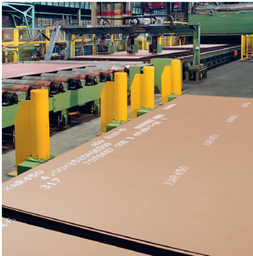
Entzunderungs- und Farbspritzanlage Descaling and priming facility
