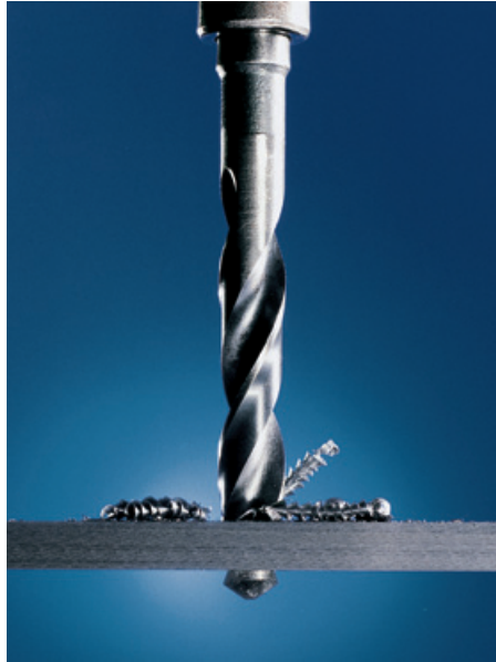
Bohren eines XAR® 400-Blech Drilling of a XAR® 400 plate
