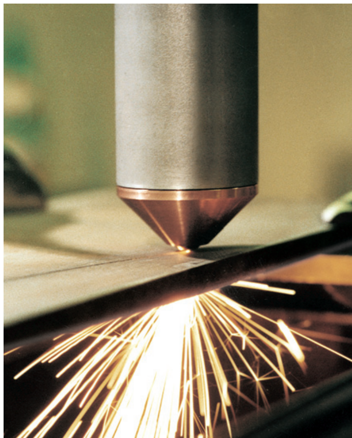
Laserstrahlschneiden Laser cutting
