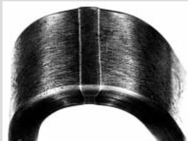
Biegeprobe quer zur Laserstrahlschweißnaht bei einem Dorndurchmesser von dreifacher Blechdicke
